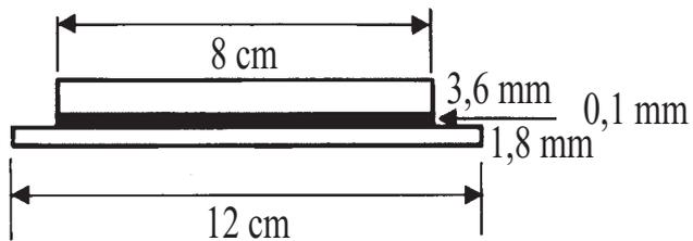
Bande realizzate in laminato elastoplastico bianco rifrangente ed antiscivolo di 8 cm di larghezza e supporto del medesimo materiale di 12 cm di larghezza.
