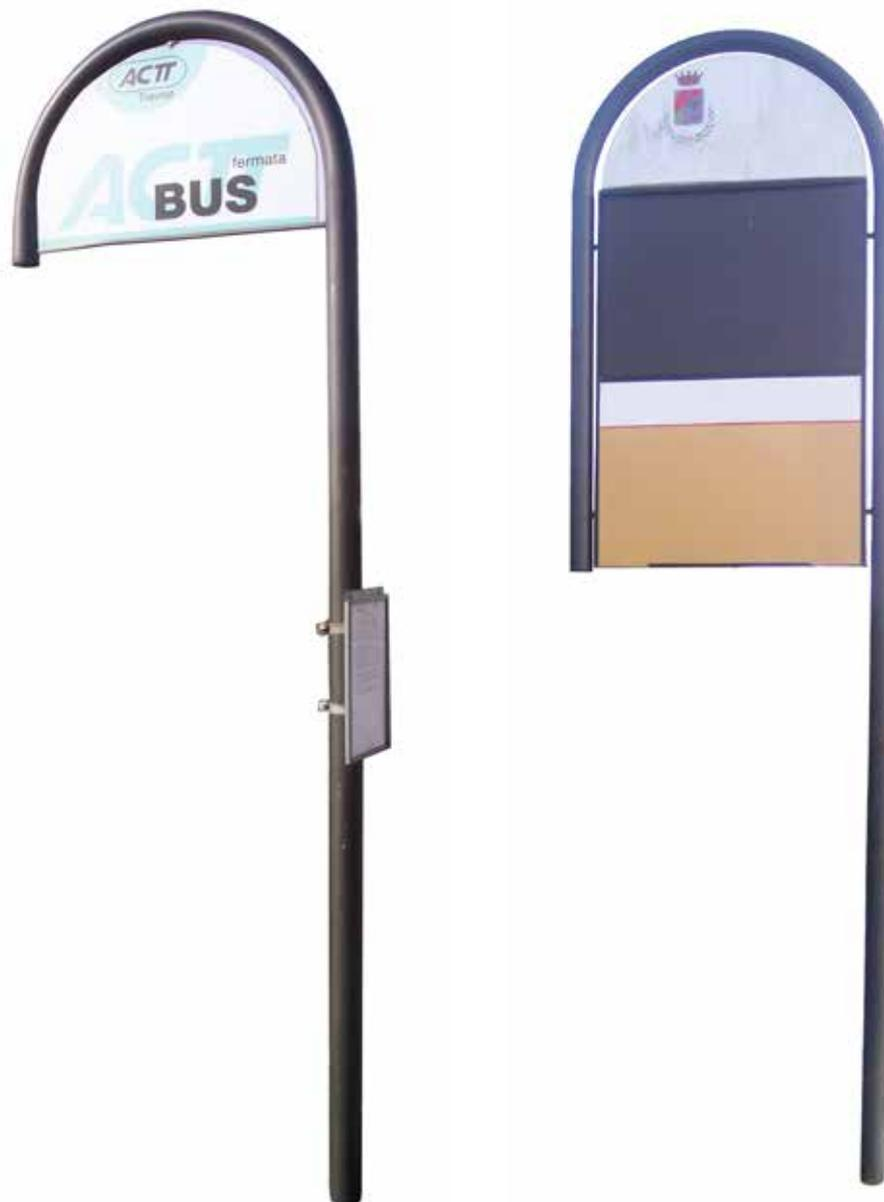
Nella palina “ARCO AUTOBUS” il sostegno è formato da un unico tubo Ø60 curvato ad arco nella parte superiore del quale viene saldato un traverso in tubolare a sez.quadra 30x30 come rinforzo e supporto del cassonetto pubblicitario. Le parti in acciaio sono zincate e verniciate a polveri poliestere termoindurenti nelle diverse colorazioni RAL. La viteria è in acciaio inox. A richiesta con bacheca porta pubblicità.
